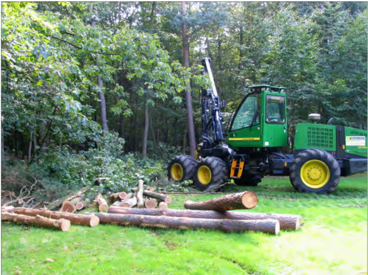
In het Pijnven gebeuren kappingen meer en meer met behulp van een zogenaamde harvester. Hiernaast detail van zaag- en grijpkop van de harvester (2005, foto J. Agten, ANB).
